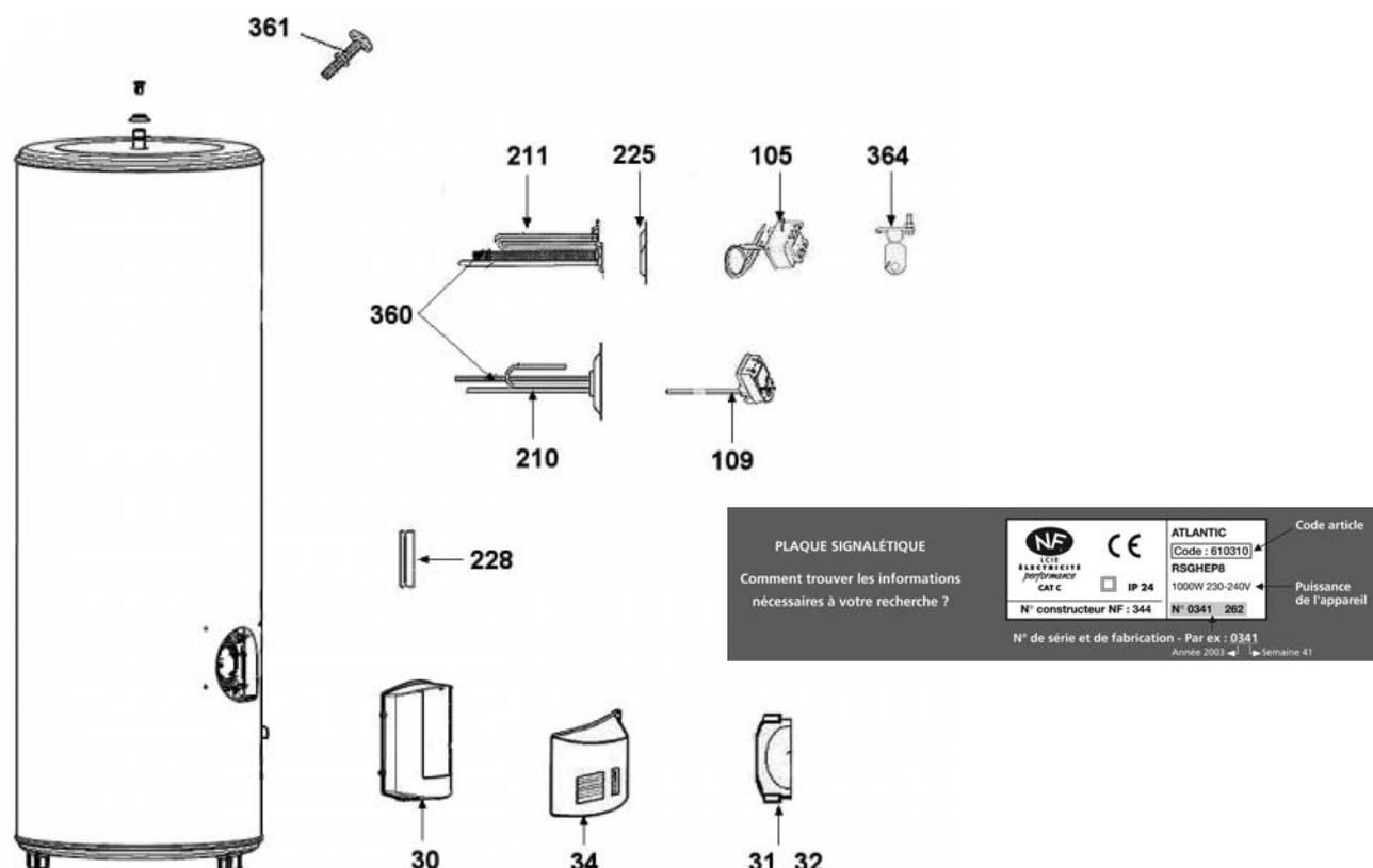
Attention: Pour les appareils monophasés fabriqués avant 1987, l'échange de la platine nécessite également le remplacement du thermostat.
