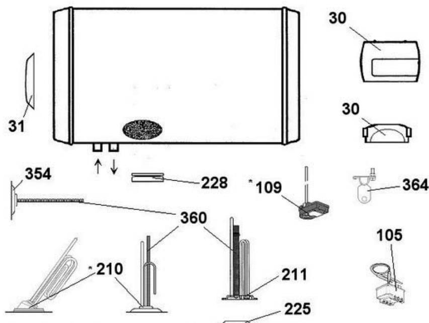
\* Attention: Pour les appareils monophasés d'avant 1987, l'échange de la platine nécessite également le remplacement du thermostat.
